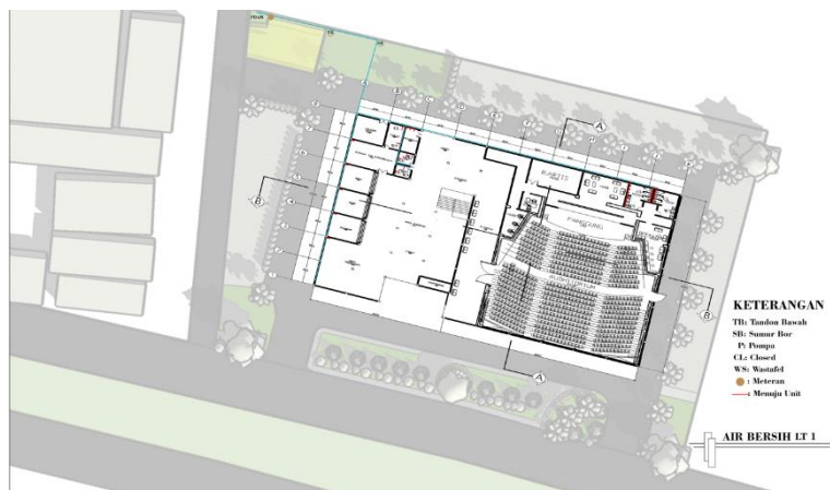
Gambar 7. Utilitas Air Bersih
