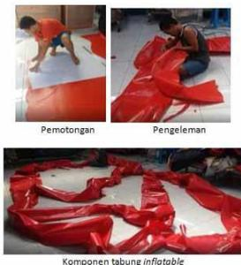
**Gambar 11:** Pembuatan Prototip Atap Panggung Tiup (2 minggu)
