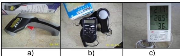
**Gambar 3.** Ragam peralatan yang digunakan dalam pengukuran: a). Infrared thermometer, b). Light meter, c) Thermo-higro clock
