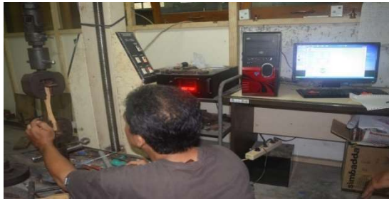
Gambar 1. Pengujian Kekuatan Lamina Bambu Terhadap Kuat Tarik Lamina Bambu
