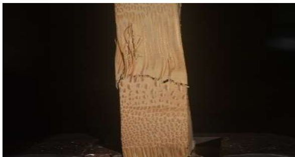
Gambar 3. Perubahan Bambu Lamina Setelah Dilakukan Uji Tarik Bambu
