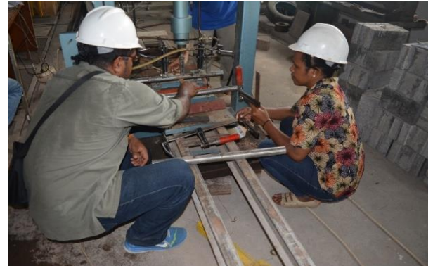
Gambar 1. Persiapan Pengujian Modulus of Elastisitas Lamina Bambu
