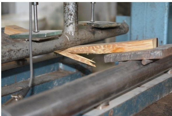
Gambar 2. Kerusakan Benda Uji Modulus Elastisitas Lamina Bambu
