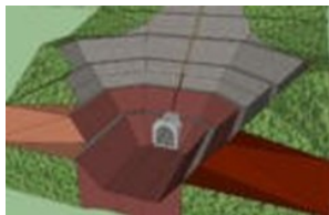
Gambar 9. Pembangunan saluran outlet dengan ormalisasi saluran ke sungai
