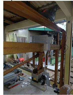
**Gambar 4.** Setting-Up Pengujian Kekuatan Tarik
