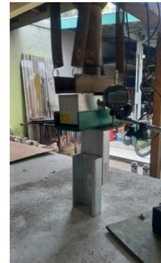
**Gambar 6.** Setting-up Uji Geser Sambungan Baja Ringan
