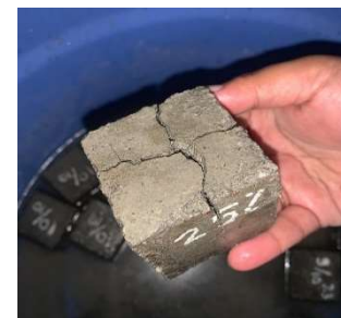
Gambar 17. Mortar Campuran Bakteri Dengan Metode Curing Perendaman Pada Air
