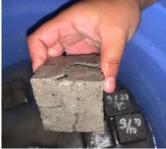
Gambar 18. Mortar Campuran Bakteri Dengan Metode Curing Perendaman Pada Air
