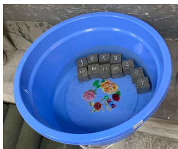
Gambar 8. Curing Mortar Dengan Air
