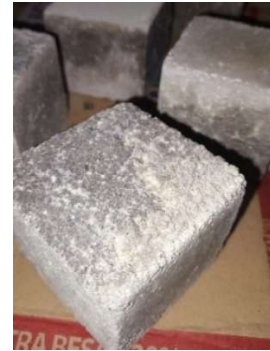
Gambar 9. Curing Mortar Dibiarkan Pada Suhu Ruang
