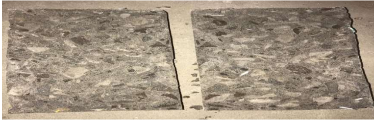
Gambar 5. Pola Retak Beton Pada Pengujian Kuat Tarik Belah
