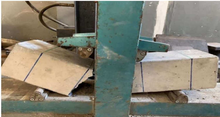
Gambar 6. Benda Uji Mengalami Patah Tengah
