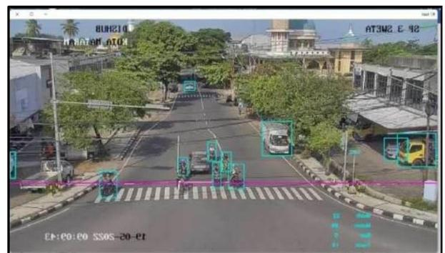
Gambar 7. Penerapan Algoritma Yolo untuk perhitungan otomatis jumlah kendaraan menggunakan data rakaman CCTV
