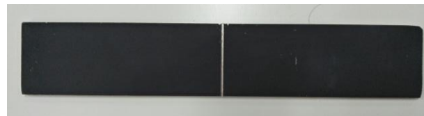
Gambar 2. Sampel uji korosi pelat API 5L-X65 diberi crack awalnya.
