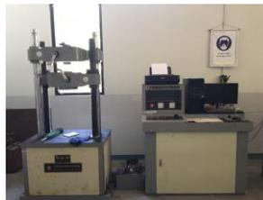
Gambar 3. Mesin Uji Tarik
