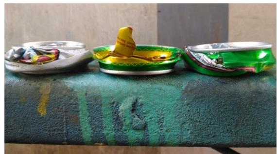
Gambar 9. pengujian dengan plat penahan 6 mm
