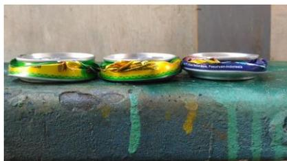
Gambar 10. Pengujian dengan plat penahan 7 mm
