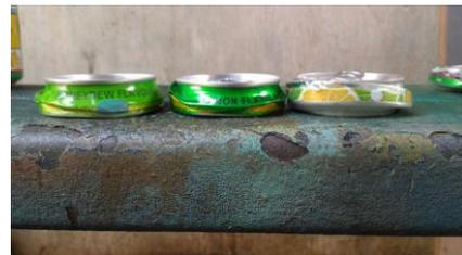
Gambar 11. Pengujian dengan plat penahan 6 mm
