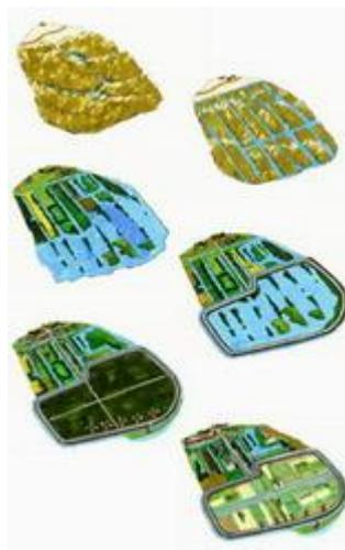
Gambar 2. Proses Pembuatan Sistem Polder Dalam Suatu Kawasan
