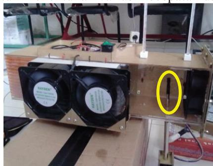
Gambar 5 Proses pengambilan data kecepatan *centerline* pada ducting
