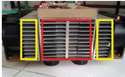
Gambar 2 Heatsink panas dan heatsink dingin pada alat pendingin ruangan
