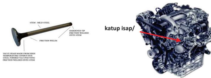
Gambar 1. Katup isap/ buang merupakan salah satu komponen otomotif yang dibuat dengan pengelasan gesek. [1].
