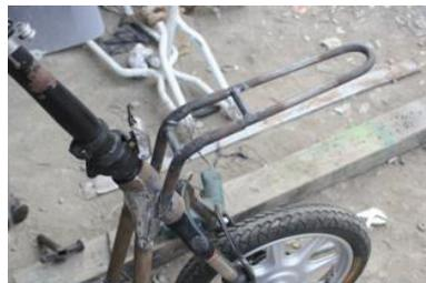
**Gambar 1.11** :Pembuatan Rangka Depan (Sumber :dokumentasi pribadi)
