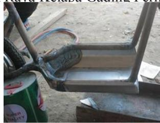
**Gambar 1.9** :Pembuatan box baterai (Sumber :dokumentasi pribadi)
