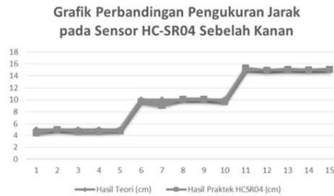
Gambar 7. Grafik perbandingan pengukuran jarak pada sensor HC-SR04 sebelah kanan
