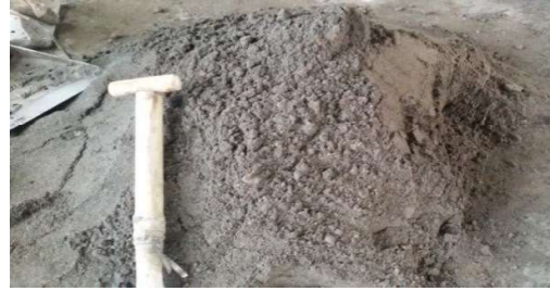
Gambar 2. Bahan campuran pasir semen dan fly ash
