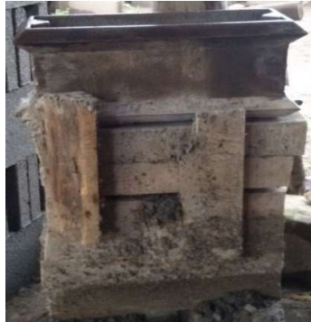
Gambar 2. Bahan campuran pasir semen dan fly ash
