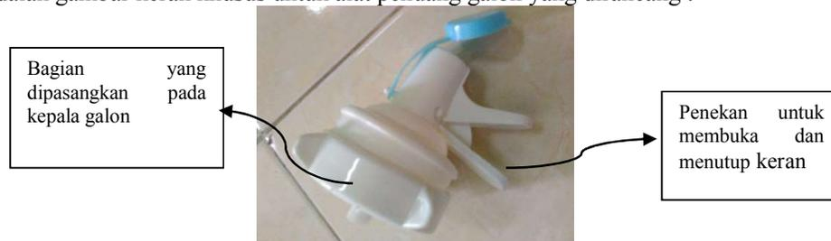
Gambar 3 Kran khusus pada alat penuang galon yang dirancang
