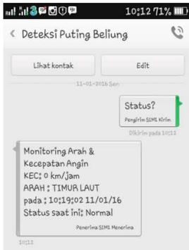
Gambar 5a. Tampilan Status Kecepatan dan Arah Angin Pada *Hand Phone* dan Balasan dari *Wavecom*
