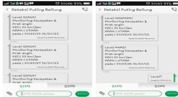
Gambar 6. Tampilan Pemberitahuan Deteksi Dini Angin Puting Beliung Pada *Hand Phone* dan Balasan dari *Wavecom*
