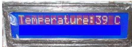
Gambar 8. Tampilan nilai suhu pada baris atas *LCD 2x16*
