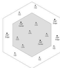
Gambar 17. Skenario manajemen interferensi pada LTE *femtocell* menggunakan metode SFR
