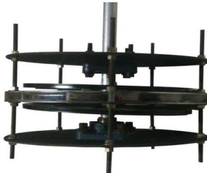
Gambar 9. Konstruksi hasil perakitan PMG
