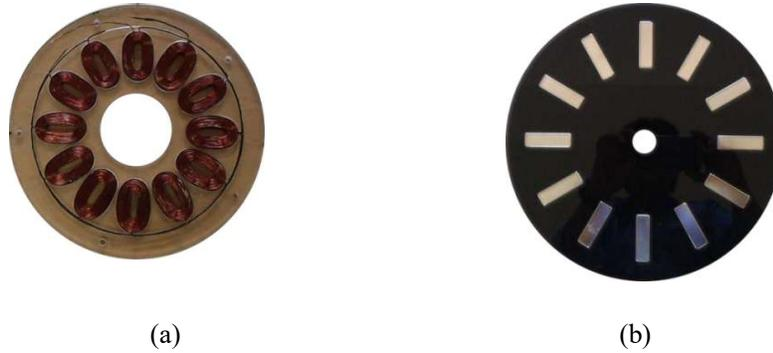
Gambar 8. (a) Konstruksi stator generator dengan 12 lilitan kumparan (b) dua rotor generator dengan 16 kutub dengan magnet permanen
