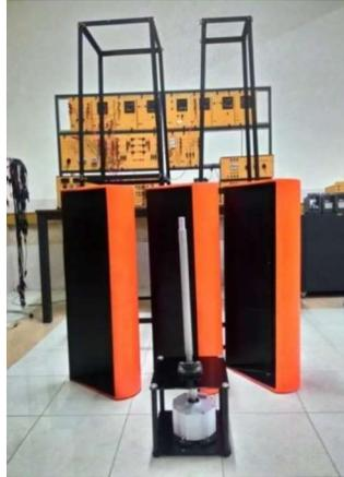
Gambar 6. Bagian-bagian kincir angin sumbu vertikal, tower dan rumah generator
