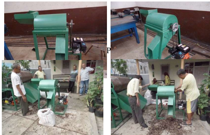
Gambar 2. Proses penggunaan Mesin Perajang Kompos
