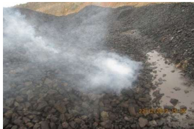
Gambar 2.3 Gejala Swabakar Pada Intermediate Stockpile [3]
