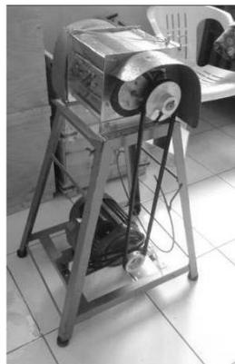
Gambar 1. Mesin pamarut kelapa
