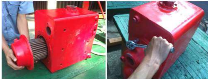
Gambar 9. Menempatkan bonnet pada posisi
