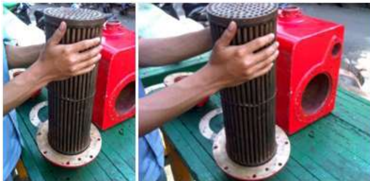
Gambar 8. Penempatan tube bundle
