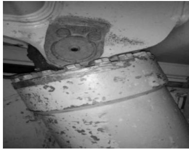
Gambar 4. Kondisi modifikasi keeper hoist setelah beroperasi 1000 jam
