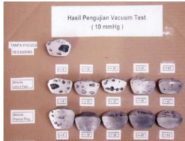
Gambar 6. Porositas coran akibat hidrogen terlarut, tingkat porositas turun setelah dilakukan degassing dengan metoda lance pipe dan porous plug. Semakin lama waktu degassing porositas semakin turun.
