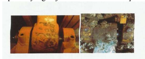
Gambar 14. Actual dudukan equalizer bar yang tidak normal
