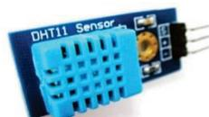
Gambar 3 Sensor DHT11<sup>[6]</sup>
