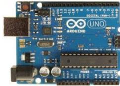
Gambar 4 Arduino Uno<sup>[7]</sup>
