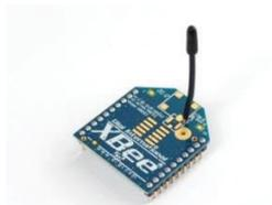
Gambar 5 Xbee S2<sup>[8]</sup>
