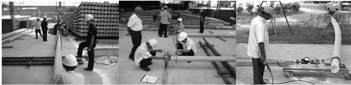
Gambar 3. Kegiatan Pengujian di Pabrik Tiang Beton & Contoh Pengujian Mekanikal <sup>[3]</sup>
