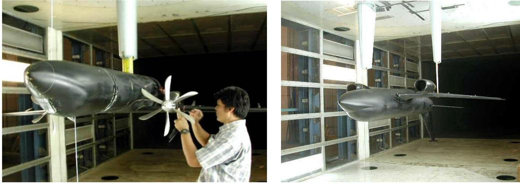
Gambar 2 Model pesawat N-250 dan N-2130 di seksi uji ILST.
