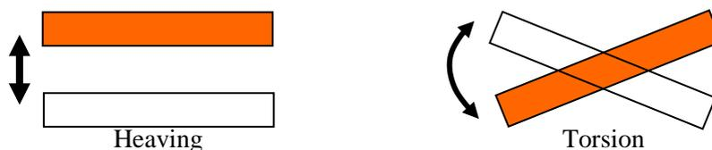
Gambar 3 Sketsa Modus Getar Model Seksional Jembatan
