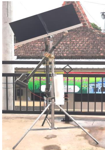
Gambar 2.2 Hasil perancangan solar tracker
