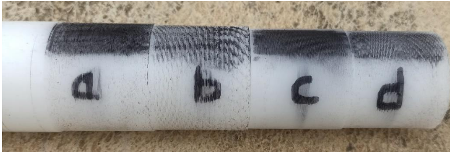
Gambar 8. Ilustrasi Hasil Pembubutan Menggunakan Sudut Pahat 75^\circ
