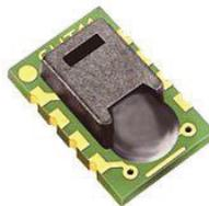
Gambar 1. Modul Sensor SHT11
