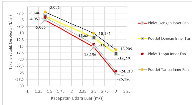
Gambar 1. Grafik Perhitungan statik inlet
