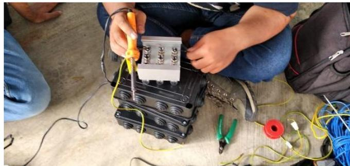
Gambar 5. *dummy load* yang Digunakan Pada Pengujian
