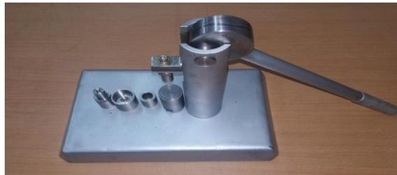
Gambar 6. Rancang Alat Pembuatan Bangun Alat Pencetak Briket Arang Pada Pemanfaatan Limbah Cangkang Biji Buah Karet
