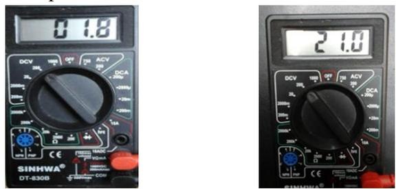
Gambar 2. (a) Output solar cell pada saat tidak terik (b) output solar cell pada saat cahaya terik
