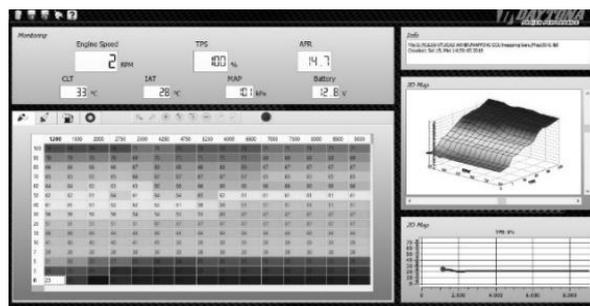
Gambar 1: Program *Mapping* Injeksi Bahan Bakar pada ECU
