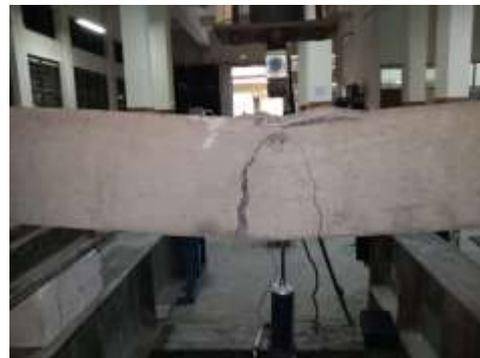
**Gambar 12.** Kegagalan Retak Beton saat tulangan pada fase *yielding*
