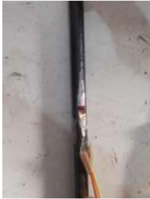
**Gambar 3.** Pemasangan Strain Gauge
