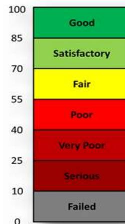
Gambar 1. Hubungan Nilai PCI dengan Kondisi Perkerasan
