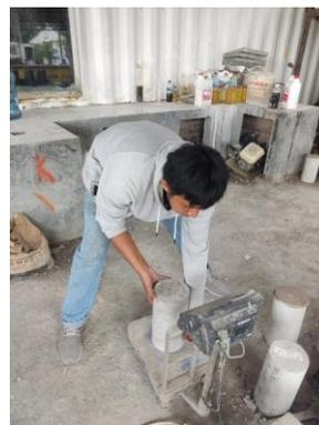
Gambar 8. Penimbangan Beton dalam keadaan kering
