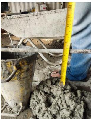
Gambar 3. Proses Untuk Slump Test
