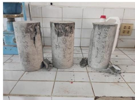
Gambar 13. Sampel Beton Setelah Diuji
