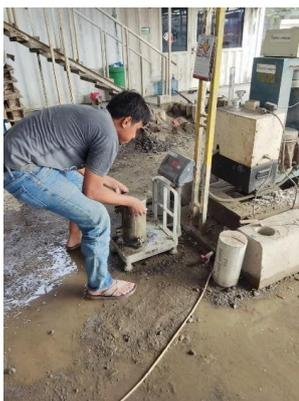
Gambar 5. Penimbangan Beton dalam keadaan basah
