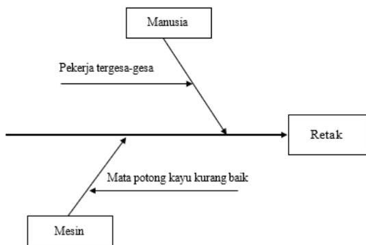
Gambar 8 *Fishbone* Diagram Cacat Retak
