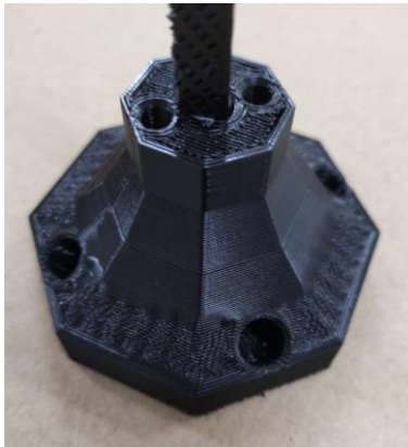
Gambar 1. Kualitas permukaan buruk pada prototype fitting lampu dekorasi Sumber: Dokumentasi pribadi, 2025
