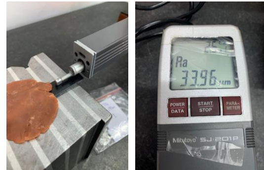
Gambar 6. Pengukuran kekasaran permukaan untuk memperoleh nilai R_a
