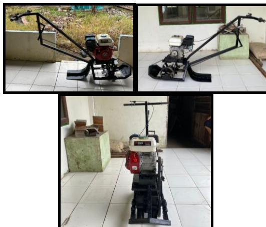
Gambar 6. Hasil Rancang Bangun Mesin Penyanggulma Sawah
