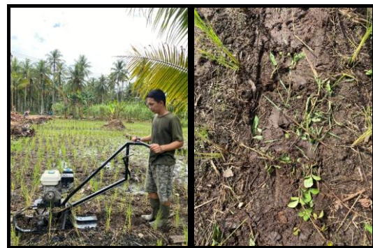
Gambar 6. Implementasi Mesin Penyanggulma Sawah
