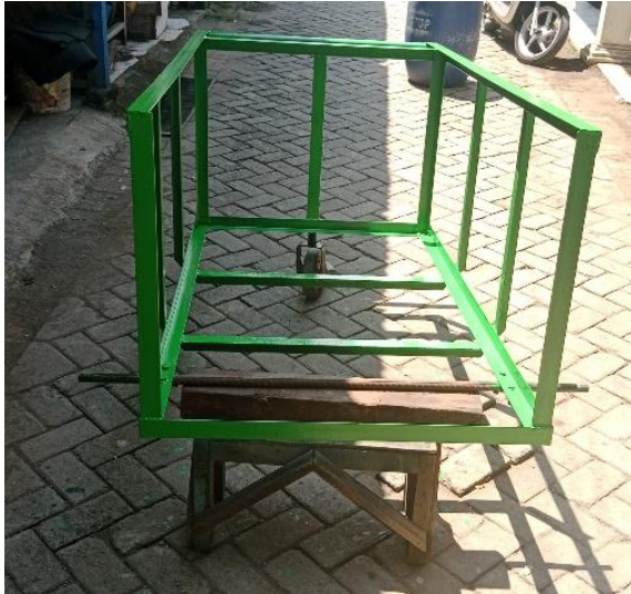
Gambar 2. Proses fabrikasi: (a) pengecatan rangka dengan cat anti karat; (b) rangka setelah pengecatan dengan roda swivel depan terpasang Sumber: dokumentasi penelitian (2026)
