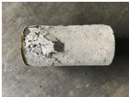
Gambar 4. 1 Pola Retak Pada Silinder Beton Ringan
